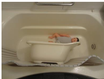
図 3-6 蓋上設置再現試験での ベビーバス転落状況
