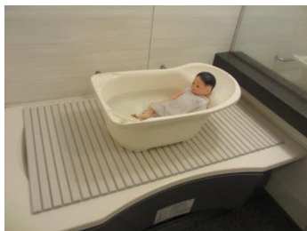
図 3-5 蓋上設置再現試験の 設定状況
