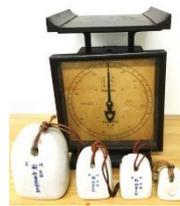
第2次世界大戦中の金属供出による金属不足により、その代用として使用された木製のばね式指示はかりと陶器製のおもり。
