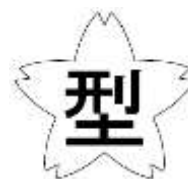
図 1-2 桜マーク(国土交通省による船舶用品型式承認のマーク)
