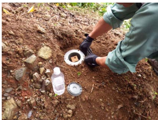
母島におけるシロアリ防除対策の取組 (シロアリの駆除方法の一つであるベイト 工法によるステーションモニタリング)
