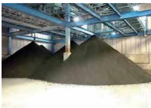
浄水場発生土
