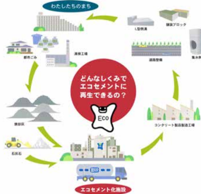
図 15 エコセメントによる資源循環の概要
