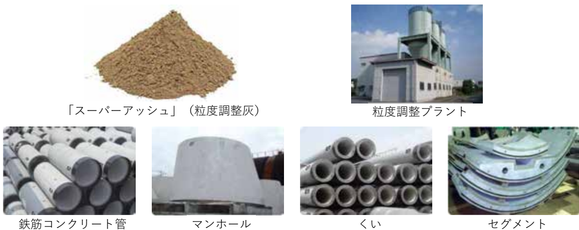
図 17 「スーパーアッシュ」（粒度調整灰）を用いたコンクリート二次製品
