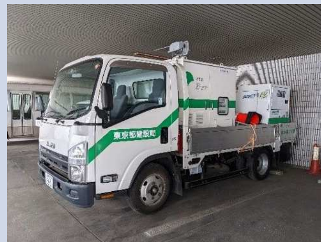
<都所有の排水ポンプ車>
