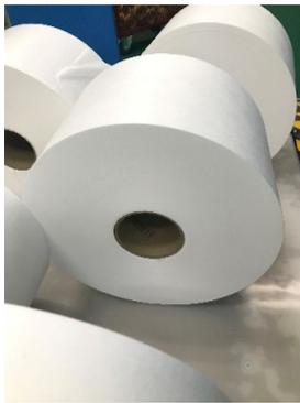
メルトブロー不織布は溶けた(メルト)樹脂をネットに吹き付けて(ブロー)、糸を作る工程を経ることなく不織布を製造する方法。この製法は他の不織布製法と比較して細い繊維径の不織布が得られること、また、接着剤などを使用しないことが特徴。不織布の繊維径が細いと小さな粒子を捕捉することができ、接着剤を使用していないのでフィルターや衛生材料等に使われている。
