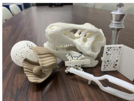
PBF(粉末床溶融結合技術)方式のハイエンド3Dプリンターメーカー。3Dプリンターの中でPBFは生産性が高く、既存技術では成しえない複雑な形状を再現することが出来る。加えてモデリングの変更も最小で済む。国内のデザイナーで3Dプリンター、特にこのPBFを用いている例はほぼ存在しないため、ファーストペンギンとしてたくさんのアイデアを期待している。
