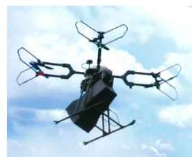
▲電磁波探査ドローン
